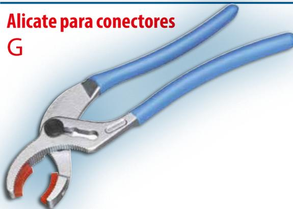
Aço especial Gedore, acabamento cromado e empunhadura plastificada. Possui articulação com três níveis de regulação. Indicado especialmente para conectores Canon ou outros e conectores roscados. Mordentes com revestimento de plástico com 11 mm de largura protegem superfícies sensíveis (aparafusados e substituíveis - ref. E 8386).
