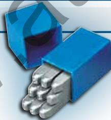
Produzido em aço de alta resistência, com pontas endurecidas. Fornecido em estojo plástico azul com 9 peças, sendo eles 0, 1, 2, 3, 4, 5, 7, 8 e 6/9 (inverter o punção para obter o 6 ou 9). Indicado para gravações manuais em placas, ferramentas, couro, etc.
